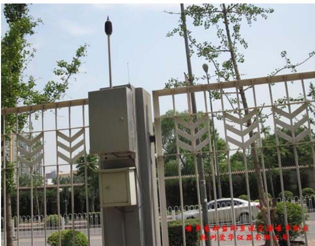
图 7.1 安装于中国环境监测总站的环境噪声自动监测系统
