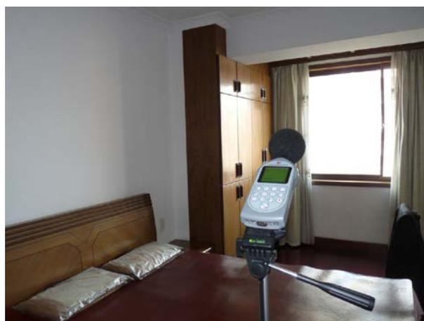
图 7.4 室内噪声测量结构传播固定设备室内噪声
