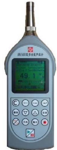
模块（选配），通过SMS(短信)将测量结果发到指定的手机或计算机上。整机性能符合GB/T 3785.1-2010/IEC 61672-2002对 2 级声级计的标准，也符合JJG 778-2005对 2 级噪声统计分析仪的要求。尤其工作温度范围为-10~+50，与1级仪器相同，更适合环境监测工作需要。
